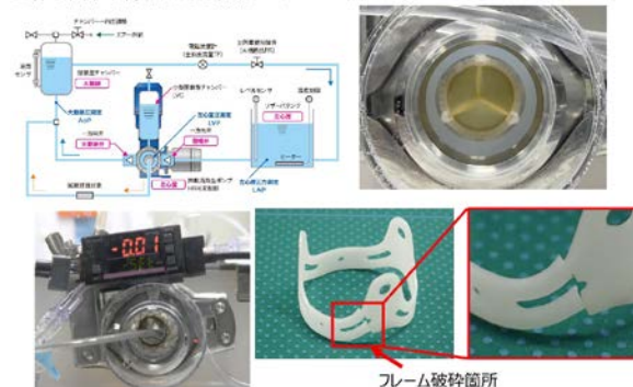
図4 大動脈圧力波形の脈圧を再現した心機能シミュレーター内での生体弁の破砕 (Medtronic 社製モザイク生体弁)。
