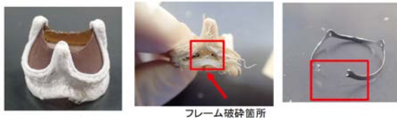
図3 High pressure balloon により破砕した最も強固な生体弁 (Edwards 社製 MagnaEase 弁)。
